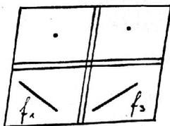
$m_2$  gleitet längs  $f$  an  $m_1$ , also auch längs irgend einer zu  $f$  parallelen Führung; z.B. längs der durch den Zapfen, der  $p_1$  und  $m_1$  verbindet.
