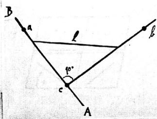
$\angle acb = \frac{\pi}{2}$ , beibehält, hat man als Strecke  $l$  die Hypotenuse irgend eines Dreiecks mit der Spitze  $c$  zu nehmen oder eine Strecke durch  $c$  selbst, die ihre Lage zu den beiden Schenkeln  $ac$  und  $bc$  nicht ändert.
