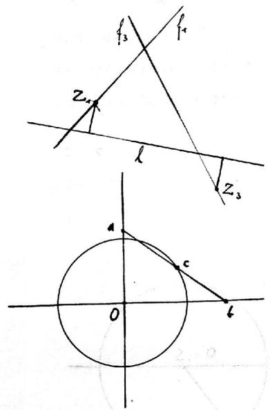
Für das Modell ist der Mechanismus dahin spezialisiert, dass die Strecke  $l$  in der Geraden  $Z_1, Z_2$  liegt und dass zweitens  $f_1$  und  $f_3$  zueinander senkrecht stehen. Dann beschreibt der Mittelpunkt  $c$  von  $ab$  einen Kreis um  $O$ , die anderen Punkte der Geraden  $ab$  beschreiben Ellipsen, die für  $a$  und  $b$  selbst zu Geraden (zweimal durchlaufen) degenerieren.
