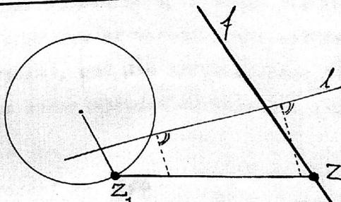
$m_3$  bewegt sich zu  $p_1$  längs  $f$ , also auch längs jeder zu  $f$  parallelen Geraden, so dass ich als Führung die durch den Zapfen  $Z$  von  $m_2$ ,  $m_3$  gehende Parallele zu  $f$  nehmen kann.  $Z$  bewegt sich jetzt also auf einer in  $p_1$  liegenden Geraden. Als Strecke  $\lambda$  in  $m_2$  nehme ich eine Strecke, die auf der Geraden durch die beiden Zapfen  $Z$  und  $Z_1$  liegt;  $Z_1$  dreht sich um  $O$ . Also besteht der Mechanismus (1112) schliesslich in folgendem:
