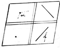
(1122) Ein Freiheitsgrad; da durch Fixierung des Winkels  $\alpha$  (ohne  $p_1, m_1$ ) die Lage von  $m_2$  und  $m_3$  auch festgelegt ist. Denn bei Bewegung von  $m_2$  beschreiben die Punkte der Führung  $f$  Kreisbögen,  $f$  verschiebt sich also nicht parallel; Bewegung von  $m_3$  bedeutet aber Parallelverschiebung von  $f$ . Oder: Durch Fixierung von  $p_1, m_3$  werden  $m_1$  und  $m_2$  wie oben festgelegt.
